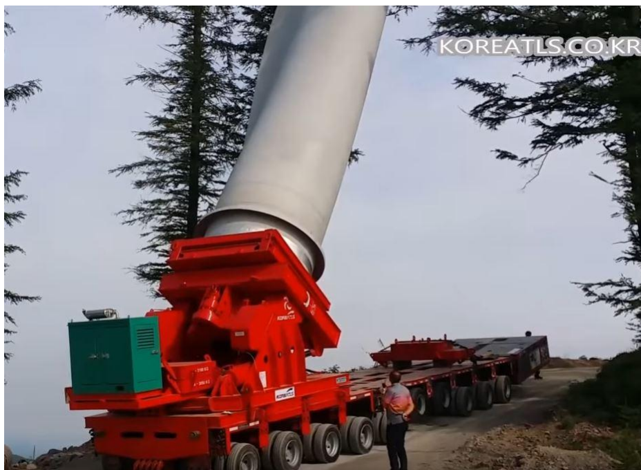
4.3.13. attēls. Speciālā tehnika VES spārnu transportēšanai
